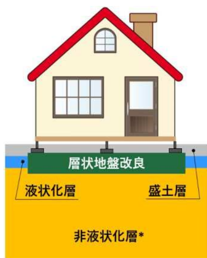
浅層混合処理工法
