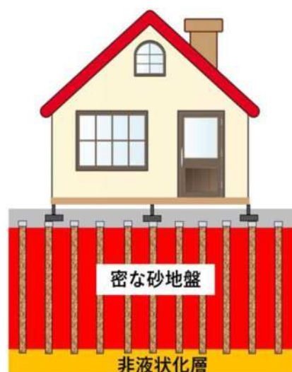
丸太打設液状化対策工法 (LP-LiC)
