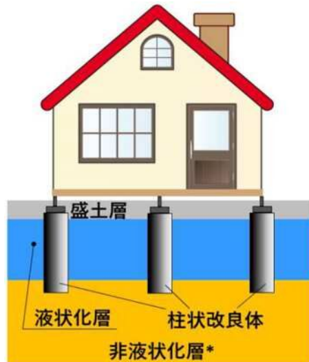
深層混合処理工法
