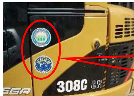
使用重機 (低騒音型重機)
